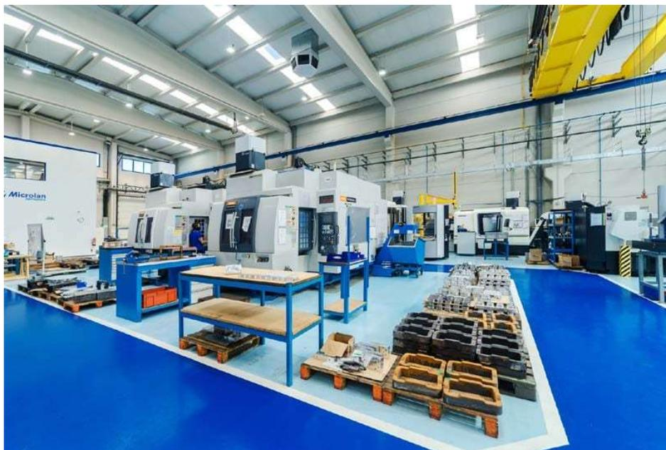
Dos centros de mecanizado vertical **Mazak Variaxis 630** equipados con doble pallet. Dimensiones máximas: 700x630x510 mm.
